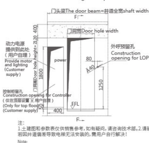
K向厅门正面图 Landing door plan
