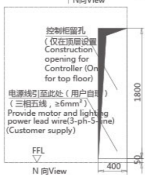
K向厅门正面图 Landing door plan
